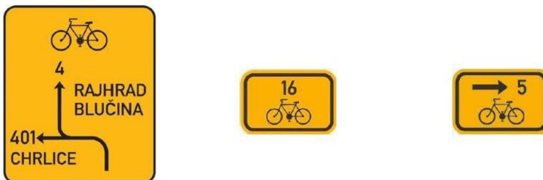
Návěst před křižovatkou IS 20 a Směrové tabulky pro cyklisty IS 21a, IS 21c.
