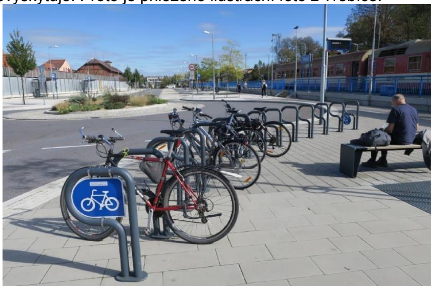
Příklad správného provedení stojanů ve tvaru písmene P v Třebíči.
